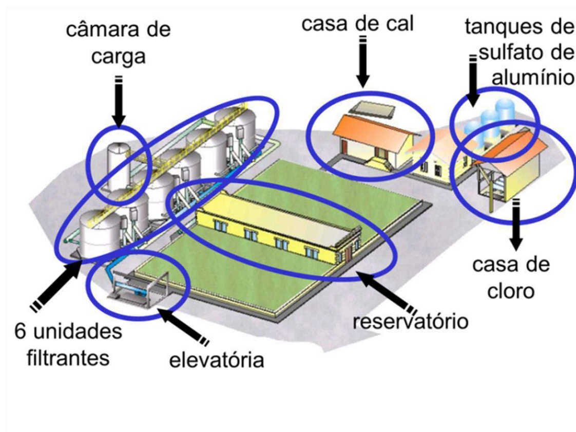
Figura 39 - Unidade de Tratamento Fonte: CAI/PMP, 2013
