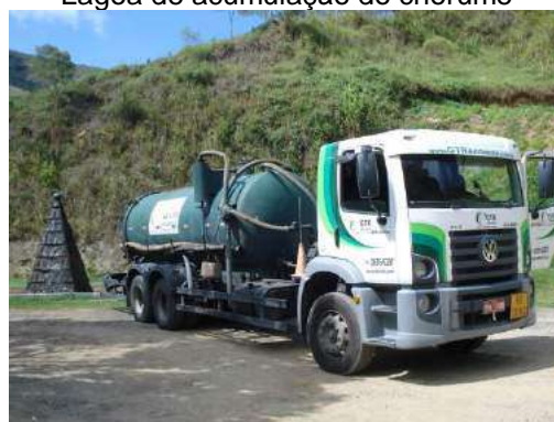
Coleta do chorume para transporte à ETE Palatinato (Águas do Imperador)
